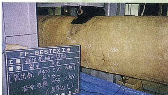
掘出しぐいの静曲げ試験
