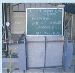
軸方向 変位量 10mm (240回の繰返し変位)
