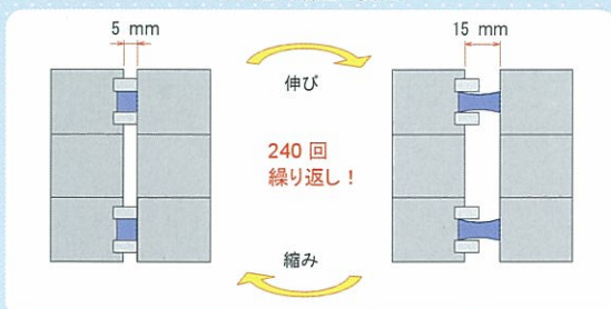
軸方向 変位量 10mm (240回の繰返し変位)
